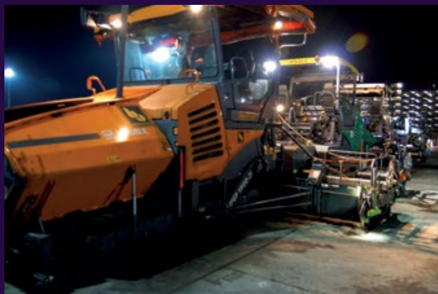
Die Fertiger in Wartestellung: Sie kommen erst am Ende der Nachtschicht zum Einsatz. Neben den beiden parallel fahrenden Maschinen steht auch immer ein Ersatzgerät bereit.
