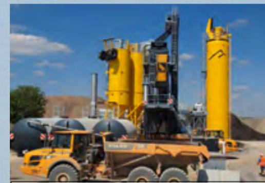
3 Mobile Mischanlagen – hier die Asphaltmischanlage – versorgen die Einbauteams und ihre Fertiger mit Asphalt, Beton und HGT-Material.
